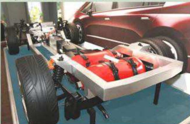
Réservoirs de 350 bar de la Honda Clarity. Elle est équipée d'une pile à combustible (PAC)
