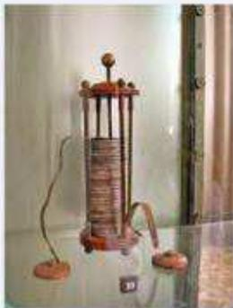
Pile à colonne de Volta
