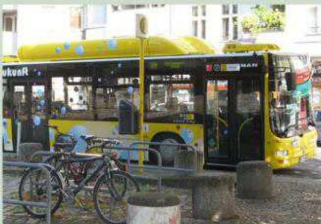
Bus équipé d'un moteur à combustion interne muni de dix réservoirs à 350 bar. Il peut transporter 80 personnes sur environ 220 km.
