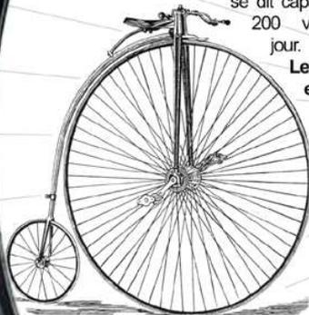
La selle, placée immédiatement derrière le guidon, déplace le centre de gravité, ce qui provoque des chutes spectaculaires. La roue arrière n'est plus qu'une roue porteuse.
