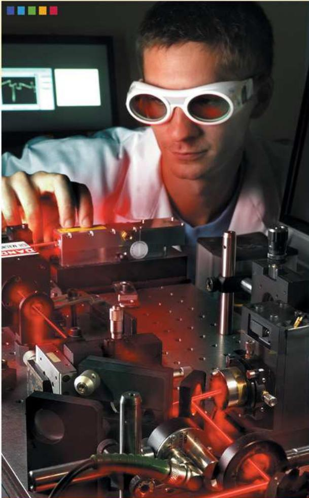
Oscillateur paramétrique compact pour la détection d'espèces chimiques (© Oniva)
